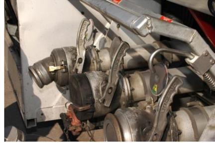
6. Pour le chargement par le bas, les bras de chargement doivent être connectés un à la fois et le flux de produit doit être confirmé dans un bras connecté avant de commencer la connexion d'un autre bras de chargement.
