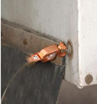
2. Branchez un câble de mise à la masse/à la terre pour éviter la production d'électricité statique. Tous les câbles de mise à la masse/à la terre et les pinces, fiches, bornes et raccords qui y sont associés doivent être maintenus propres, non peints et en bon état.
