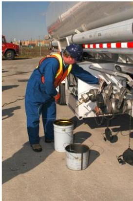
7. Placez des seaux par terre pour recueillir les gouttes sous les appareils de robinetterie de chargement/déchargement. Voici des seaux de métal utilisés pour recueillir l'égouttement des flexibles ou des appareils de robinetterie. Ils sont dotés de poignées non isolées de même que d'une tresse de masse pour éliminer l'électricité statique. On ne doit utiliser que des seaux de métal parce que les seaux de plastique emmagasinent l'électricité statique.
