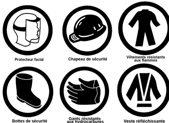
Dans le cas de l'asphalte, il faut porter des vêtements amples et résistants au feu, avec un col fermé ainsi que des manches longues et boutonnées aux poignets.
