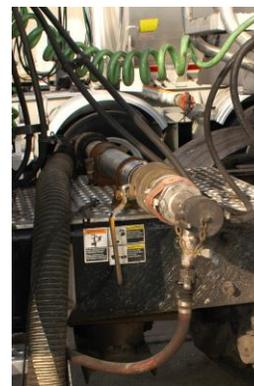
Le système de pompage devrait être mis à l'essai périodiquement afin de s'assurer que le limiteur de pression fonctionne et limite convenablement la pression de refoulement de la pompe.
