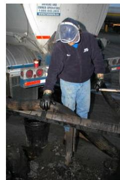
La continuité électrique des flexibles devrait également être vérifiée lorsqu'ils sont soumis à des essais de pression.
